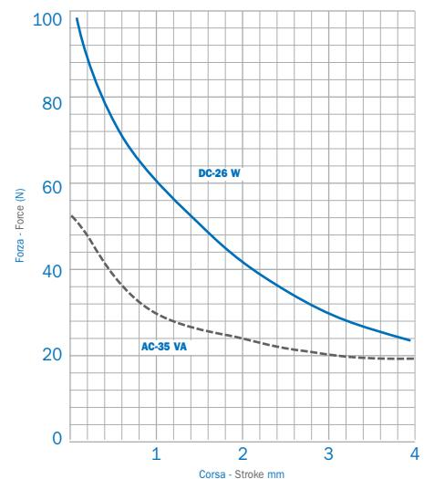
Curve rilevate in funzione degli attuatori utilizzati con tensione nominale ridotta del 10%. I valori riportati sono indicativi.
