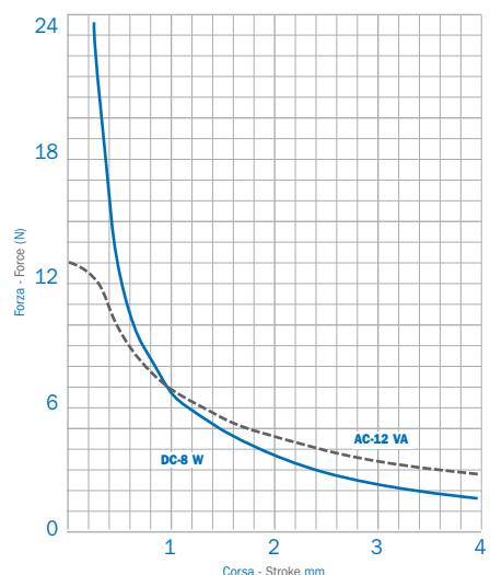
Curve rilevate in funzione degli attuatori utilizzati con tensione nominale ridotta del 10%. I valori riportati sono indicativi.
