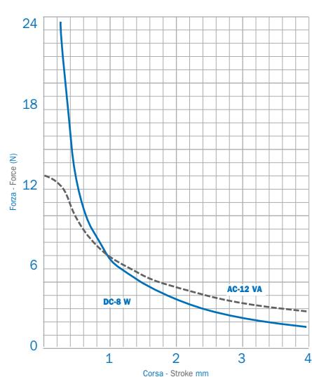
Curve rilevate in funzione degli attuatori utilizzati con tensione nominale ridotta del 10%. I valori riportati sono indicativi.
